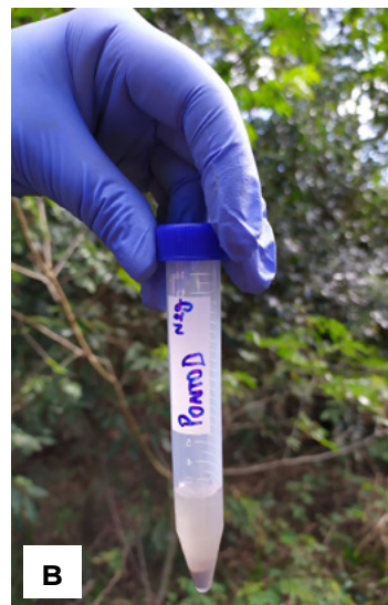
Figura 1. Resultado do teste de campo após 5 min. A cor em tons de vermelho no tubo A indica solo hidromórfico. No tubo B não há presença de solo hidromórfico.
