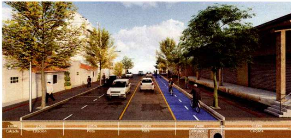
Figura 11 – Exemplo de gabarito viário em determinada via.
