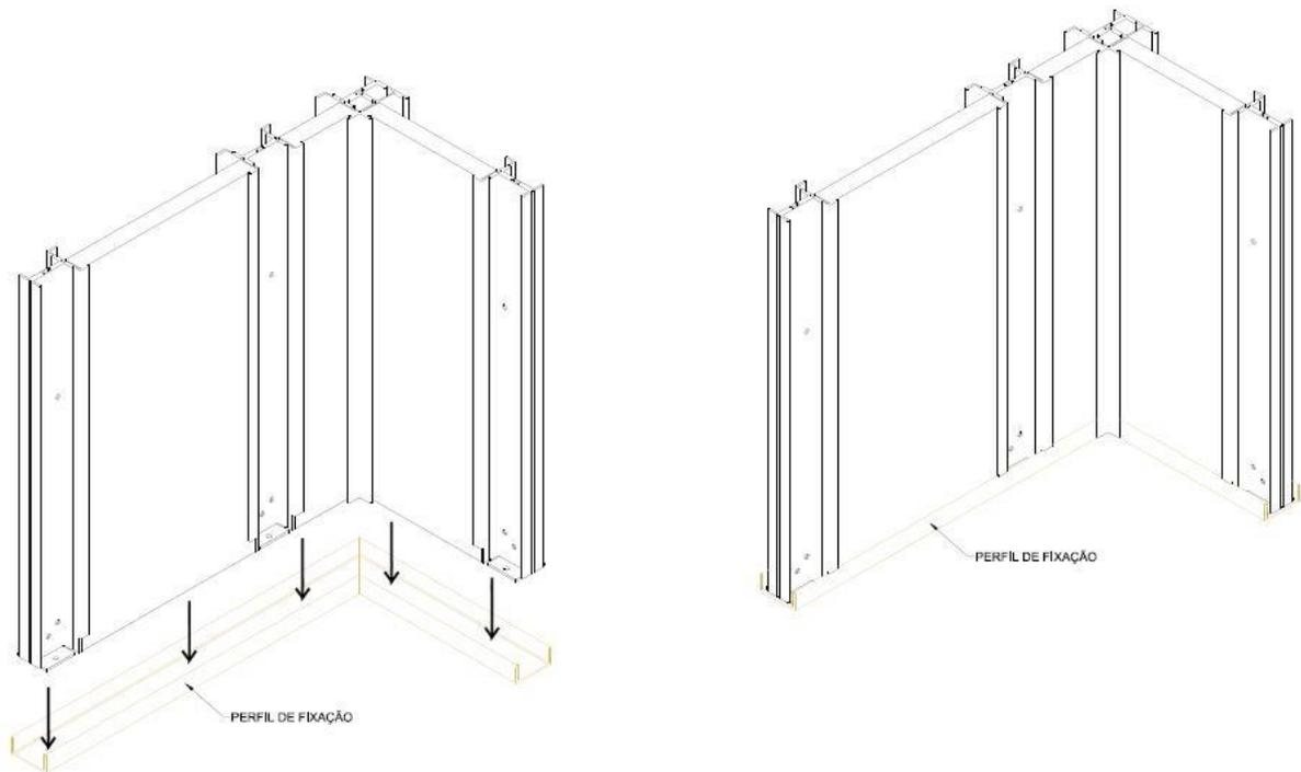
Figura 6 - Detalhe da instalação do perfil de fixação.
