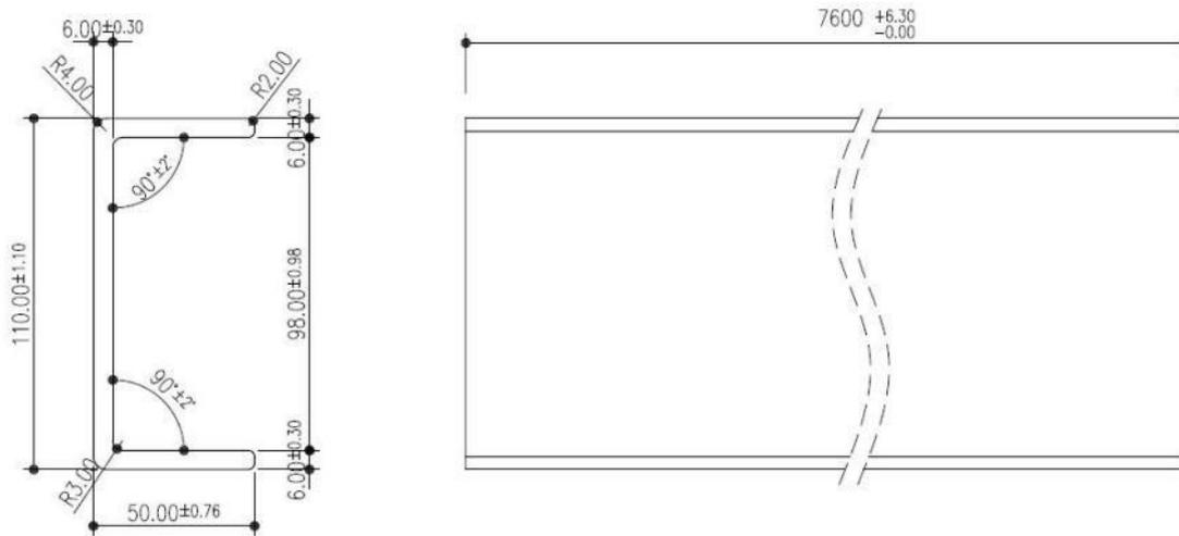
Figura 5 - Descrição dos perfis de fixação.
