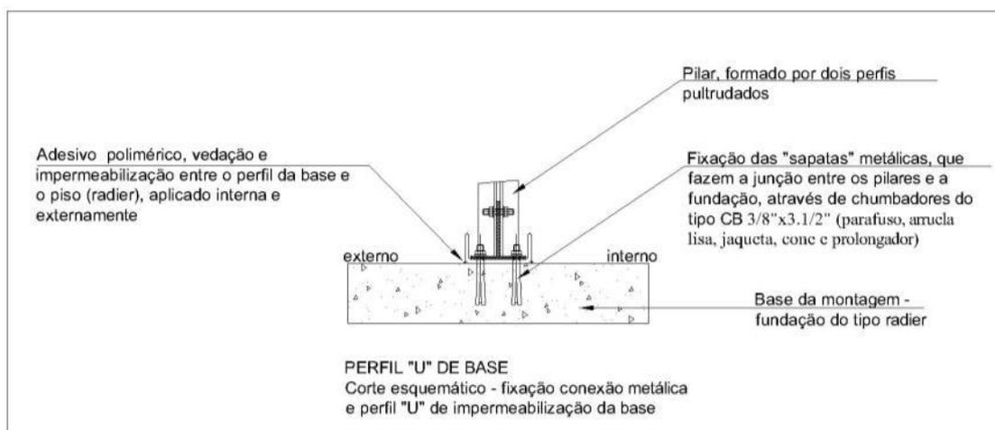
Após concluída a cura do concreto da fundação, o piso será demarcado para que seja instalado o perfil pultrudado (que afasta e isola todo o conjunto da edificação do piso, promovendo sua impermeabilização e acabamento), conforme projeto arquitetônico, nas bases das paredes.
