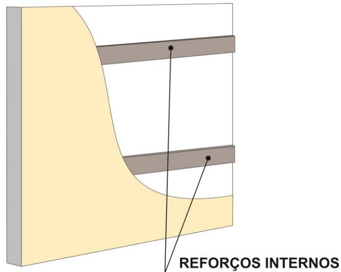
O painel de forro é constituído de placas poliméricas laminadas e o núcleo de Poliestireno Expandido EPS auto-extinguível tipo F1, com espessura final de 50 milímetros e acabamento voltado para o interior do ambiente com pintura intumescente.
