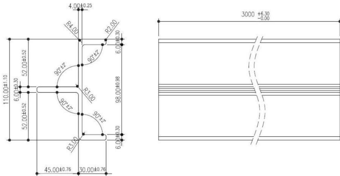
Figura 9 - Especificação dos perfis de borda para painéis.
