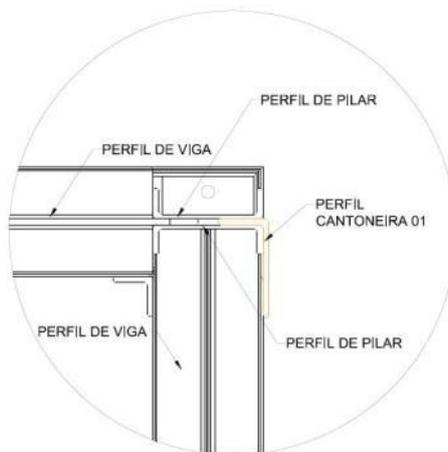
Figura 15 - Esquema de montagem perfil cantoneira 01.
