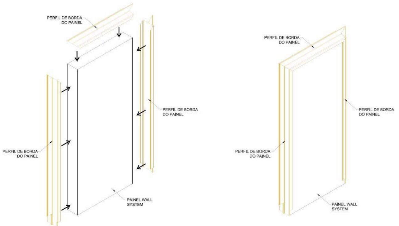
Figura 10 - Detalhe da instalação dos perfis de borda.
