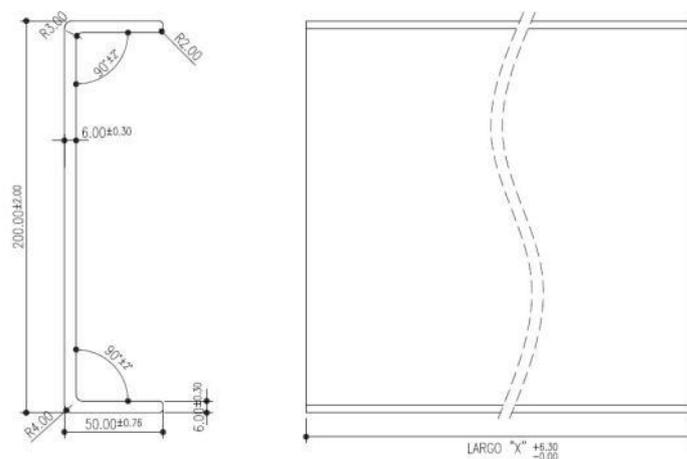
Figura 1 - Especificação do perfil para a viga.
