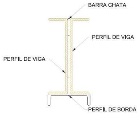
Figura 2 - Detalhe da instalação das vigas.
