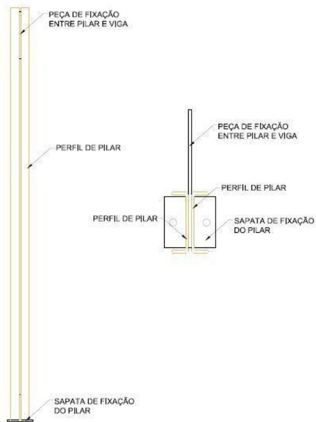
Figura 4 - Detalhe da instalação do pilar.
