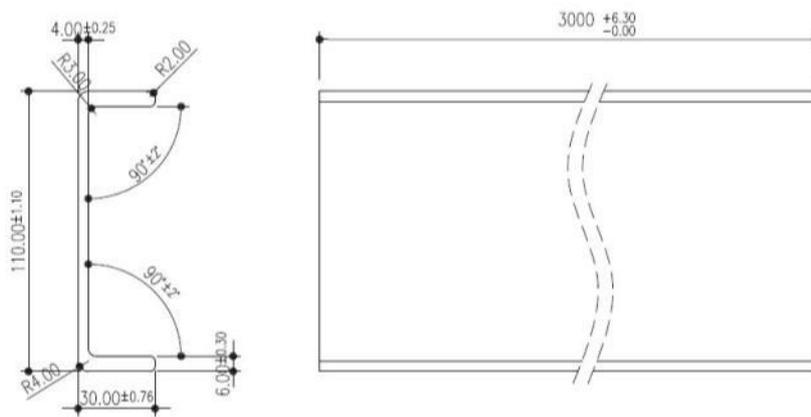
Figura 3 - Especificação do perfil para pilar.
